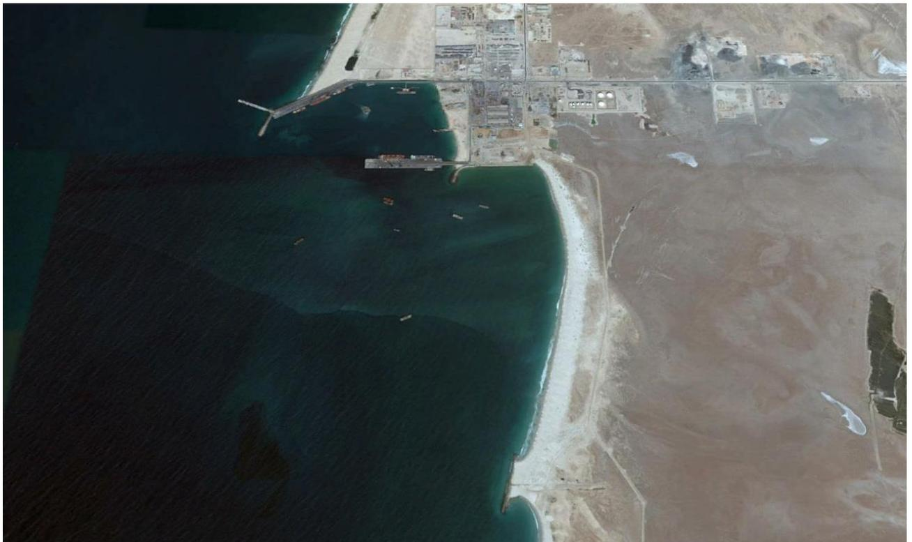
Evolution du port de Nouakchott et infrastructures associées entre 2011 (en haut) et 2015 (en bas). Les principales évolutions concernent : (i) Construction d'un nouveau quai (2013), (ii) extension du brise lame/ digue de protection de 5km vers l'ouest et (iii) construction d'un brise lame / enrochements au sud du port permettant d'atténuer l'érosion.
